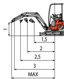
La capacité de levage est basée sur la norme ISO 10567 est elle ne dépasse pas au-delà du 75% du charge statique de basculement ou au-delà du 87% de la capacité de levage hydraulique de la machine.
