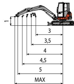
La capacité de levage est basée sur la norme ISO 10567 est elle ne dépasse pas au-delà du 75% du charge statique de basculement ou au-delà du 87% de la capacité de levage hydraulique de la machine.
