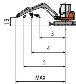
La capacité de levage est basée sur la norme ISO 10567 est elle ne dépasse pas au-delà du 75% du charge statique de basculement ou au-delà du 87% de la capacité de levage hydraulique de la machine.
