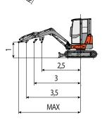
La capacité de levage est besée sur la norme ISO 10567 est elle ne dèpasse pas au-delà du 75% du charge statique de basculement ou audelà du 87% de la capacité de levage hydraulique de la machine.
