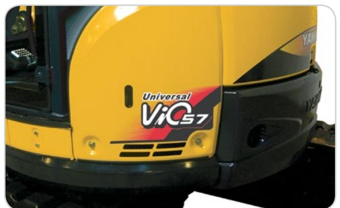
> Forme du contrepoids conçue pour protéger les tôles latérales contre les chocs éventuels. Ajout dans le châssis supérieur de pièces moulées sur les angles extérieurs droit et gauche, améliorant ainsi la résistance aux chocs.
