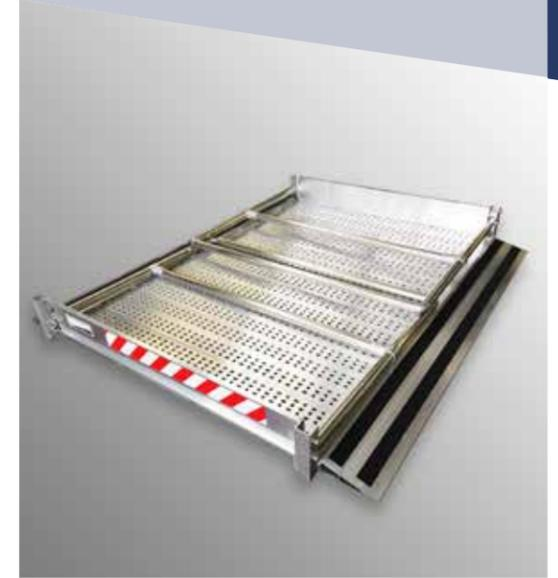
La passerelle piétonnée DIMA, dotée de plinthe et garde corps repliable, est produite en alliage d'aluminium. Elle est produite conformément aux lois applicables: UNI EN 1398:2009 et UNI EN ISO 14122-3. Elle est produite en surface antidérapante. Les gardes corps sont montés à hauteur de 1 mètre.
